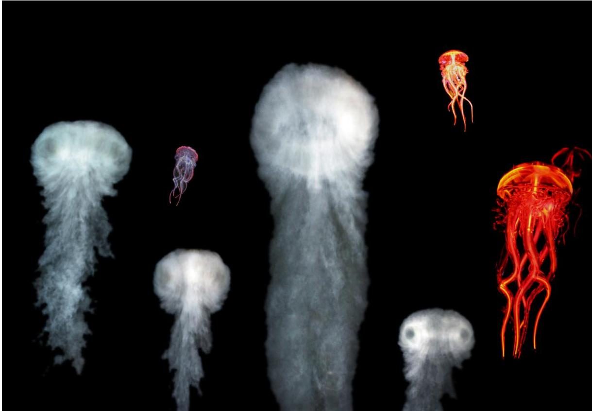
Feinst zerstäubtes Wasser steht in einem Behältnis. Dies ist mit einer Gummimembran abgeschlossen, in deren Mitte ein großes Loch klafft. Wird die Membran schlagartig heruntergedrückt, entspringt der Dampfkammer eine Wolke, die langsam aufsteigt. Die Partikel steigen aber nicht gradlinig hoch, sondern stauen sich im vorderen Teil. Dabei bildet sich eine Form, die an eine Qualle erinnert. Von unten geschickt angeleuchtet, bekommt dieser in sich pulsierende Dampfkörper etwas Lebendiges.
